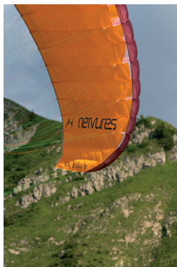
Le joli sac Nervures Nano, 55 litres, léger, technique et d'un très bon portage. Discrètes facettes d'intradados en V, cellules demi-fermées, la conception de la Whizz est très élaborée. Et les élévateurs, ici la version drisses Dyneema avec afficheurs.
