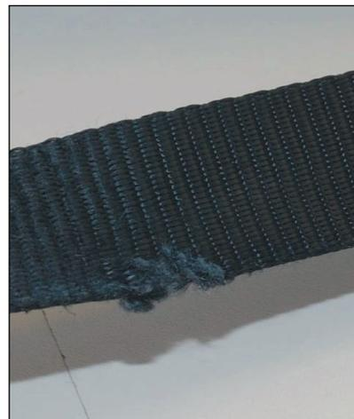
Photo 1 : exemple de sangle endommagée
