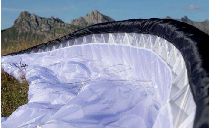
Shark-nose en bord d'attaque, très bien structuré mais léger, avec joncs de mise en forme et renforts en tissu laminé.
