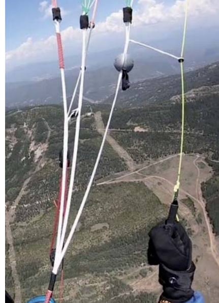
Disponibles en option, les élévateurs light avec soft-links, font gagner 200 grammes. En conservant la boule de pilotage sur les C.
