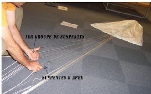
Démêler les suspentes et les suspentes d'apex.
