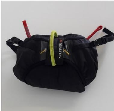
Placer les aiguilles ou le jonc jaune du centre vers l'extérieur du conteneur en les glissant dans le loop correspondant puis dans le fourreau de protection.
