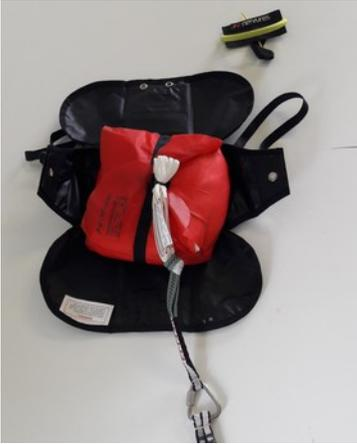
Relier les élévateurs entre la voileure et le conteneur par un Maillon rapide (carré ou triangle) en acier inox de diamètre 5 mm minimum. Serrer  $\frac{1}{4}$  de tour à la clé.
