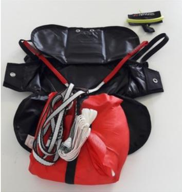
Velcroter les élévateurs au fond du conteneur (conteneur type 1) et disposer les éléments de connexion puis le POD par-dessus.
