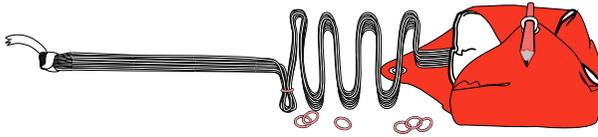
Lover les suspentes en faisant des boucles aussi larges que le POD en prenant bien garde de ne pas les torsader. Les fixer avec les élastiques . Laisser environ 20cm non lové
