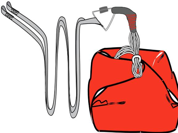
Fermer le Pod en enfilant dans l'oeillet le cordon élastique et en y passant une boucle de suspenste.
