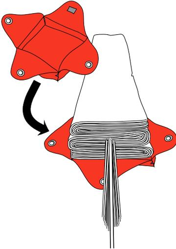
Placer le POD sous le secours afin de contrôler la bonne largeur du pliage.
